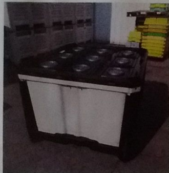
LE MODULE JANNY MT EST COMPOSÉ D'UN CAPOT équipé de plusieurs membranes et d'un bac de 610 litres. L'ensemble forme un module individuel d'atmosphère contrôlée.
